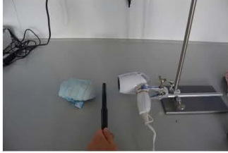
Abbildung 25: Versuchsaufbau (Luftfeuchtemessung fönzugewandte Seite). Eigene Abbildung ©rgeo
