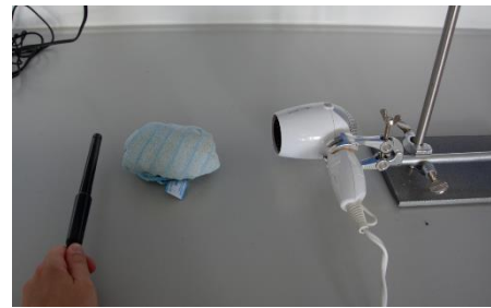
Abbildung 26: Versuchsaufbau (Luftfeuchtemessung fönabgewandte Seite). Eigene Abbildung ©rgeo
