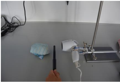
Abbildung 25: Versuchsaufbau (Luftfeuchtemessung fönzugewandte Seite). Eigene Abbildung ©rgeo
