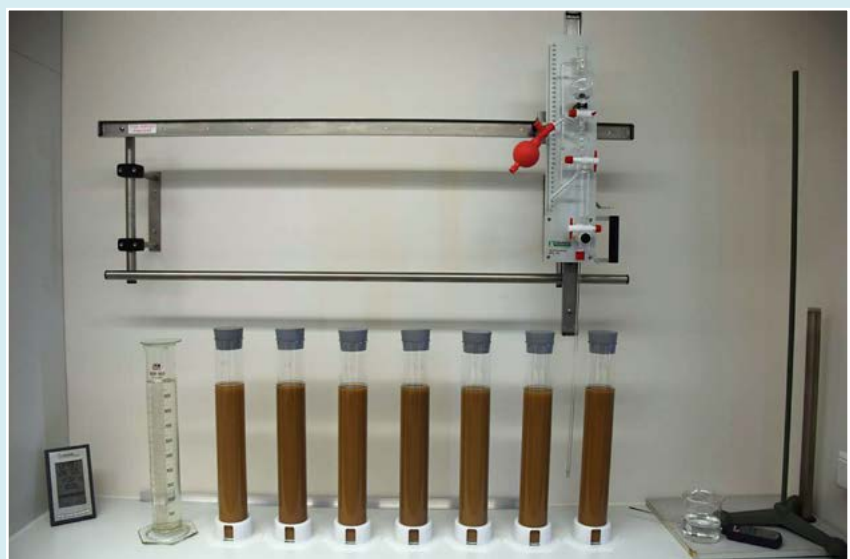
Abb. 3: Versuchsaufbau zur Bestimmung der Korngrößenfraktion < 0,063 mm mittels Pipettverfahren nach Köhn
